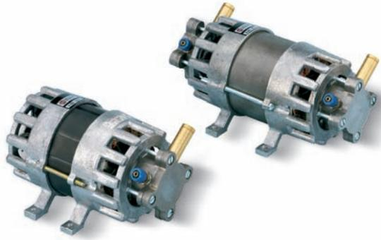
Sono piccolissime pompe per vuoto a palette rotative che, all'occorrenza, possono essere impiegate anche per comprimere aria. Sono costituite da un motore elettrico monofase ad induzione con condensatore, uno statore in metallo sinterizzato autolubrificante, un rotore in metallo bianco calettato sull'albero motore e scanalato per l'alloggiamento delle palette in acciaio temprato e un silenziatore sullo scarico.
